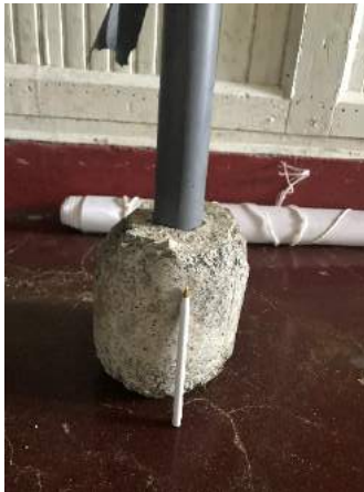
Imagen 5. Bloque de hormigón para el sensor de presión.
